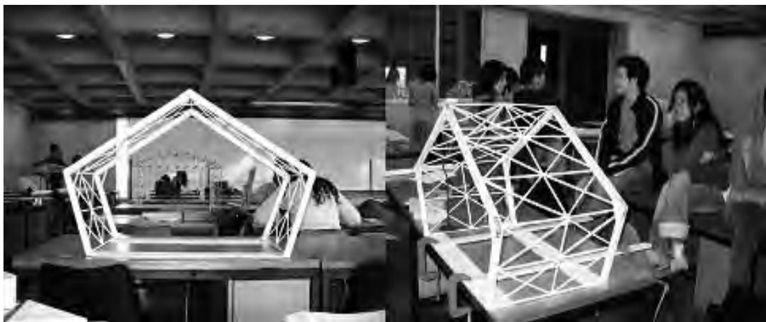
Otro diseño para soportar las mismas cargas que la maqueta anterior.
