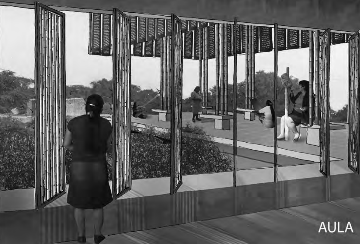
Vista interior del aula. Se escogió un diseño calado para tamizar la radiación; el tejido tiene un borde más tupido, es de junco con anchos variables entre 50 cm y 80 cm; ellos se amarran a la estructura de caña. Las esterillas son hechas por las artesanas, se busca involucrarlas y que se sientan parte del proyecto desde su construcción.
