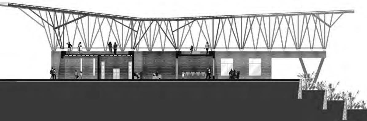
Corte del proyecto. Usos comerciales/definidos en el primer nivel y usos flexibles en el segundo nivel, reflejado en la materialidad.
