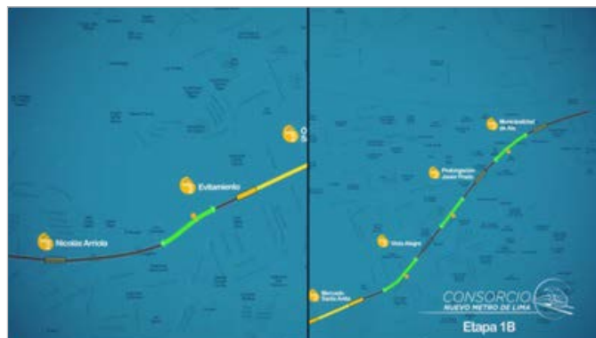
Figura 8. Se avanzará desde el mercado Santa Anita hasta la municipalidad de Ate y de Evitamiento a Nicolás Arriola por método convencional de excavación. Fuente: AATE
