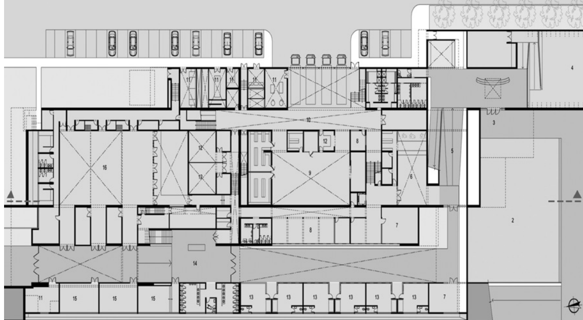
1) Plaza CITE-LAC / 2) Espejo de agua / 3) Ingreso / 4) Sala de exposiciones / 5) Hall de distribución / 6) Zona de venta a productores / 7) Sala de reuniones / 8) Oficina / 9) Miniplanta procesadora / 10) Andén de carga y descarga / 11) Sala de máquinas / 12) Laboratorio / 13) Of. incubadora de empresas / 14) Ingreso centro de convenciones / 15) Aula / 16) Sala de usos múltiples (SUM) / 17) Circulación de visitantes / 20) Cocina / 21) Cafetería – restaurante / 25) Mirador.
