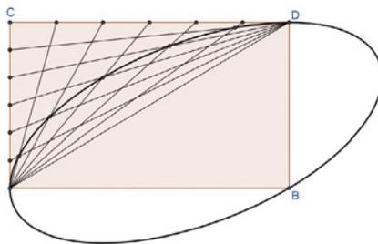
Figura 9: construcción de puntos de una elipse.
