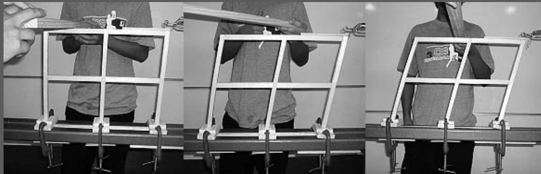
Maqueta de una estructura en madera balsa ensayada hasta la falla por una carga lateral.
