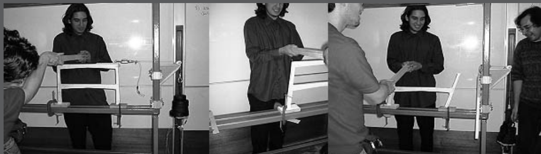
Otra maqueta ensayada hasta el colapso también por una carga lateral. A la derecha, se puede notar el dispositivo de carga y las pesas utilizadas.
