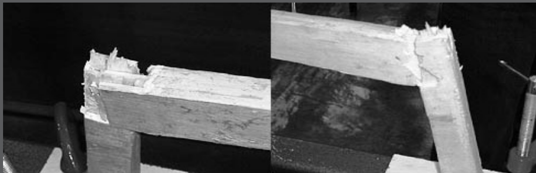
Detalles de falla en los elementos de unión de la maqueta anterior.
