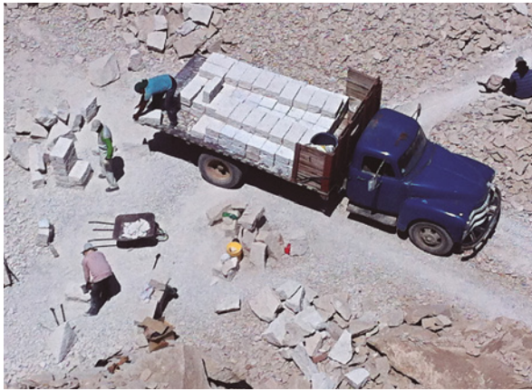
Figura 5. Una Tarea consiste en labrar 200 bloques de sillar, los cuales son transportados desde la cantera a distribuidores de materiales en la ciudad.
