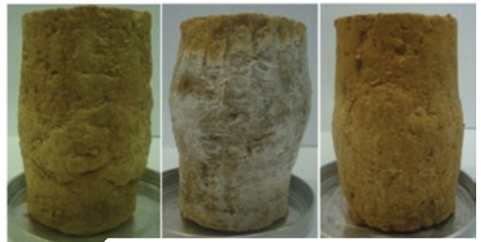
Cuerpos de prueba con mixtura de 60% de suelo puro y 40% de ceniza volante con 60 días de tiempo de cura, que arrojó los mejores resultados.
