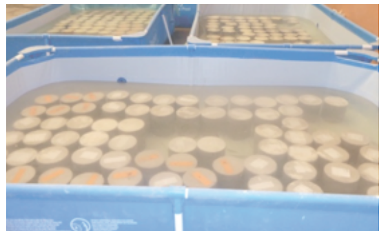
Figura 1. Lote de probetas curadas con cal 3gr/t
