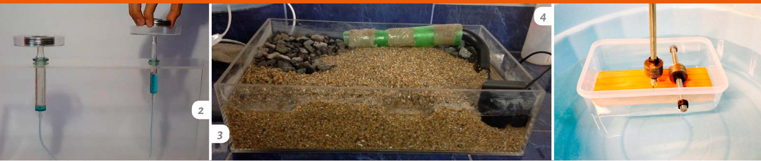
Figura 2/ Modelo de prensa de pascal realizado por los alumnos que demuestra que variando los diámetros del sistema que una dos pistones hace variar la fuerza generada. Figura 3/ Modelo de Agotamiento de agua que muestra la variación de niveles de fluido en un medio poroso al extraer caudal. Figura 4/ Modelo para demostrar la estabilidad de un cuerpo flotante y la relación con el cambio de centro de gravedad y metacentro.
