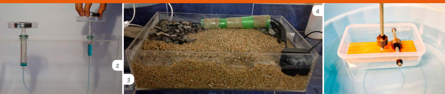
Figura 2/ Modelo de prensa de pascal realizado por los alumnos que demuestra que variando los diámetros del sistema que uno dos pistones hace variar la fuerza generada. Figura 3/ Modelo de Agotamiento de agua que muestra la variación de niveles de fluido en un medio poroso al extraer caudal. Figura 4/ Modelo para demostrar la estabilidad de un cuerpo flotante y la relación con el cambio de centro de gravedad y metacentro.
