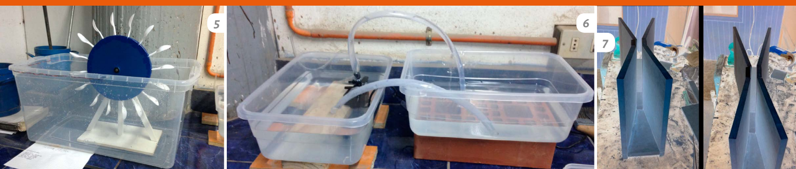
Figura 5 Máquina para demostrar la posibilidad de generación eléctrica a través del movimiento causado por el impacto del agua en sus alabes. Figura 6 Sistema de sifón y bomba para demostración de la existencia de presiones negativas en sistemas de funcionamiento gravitatorios. Figura 7 Construcción de aforador Parshall para medición de caudales en flujo crítico.
