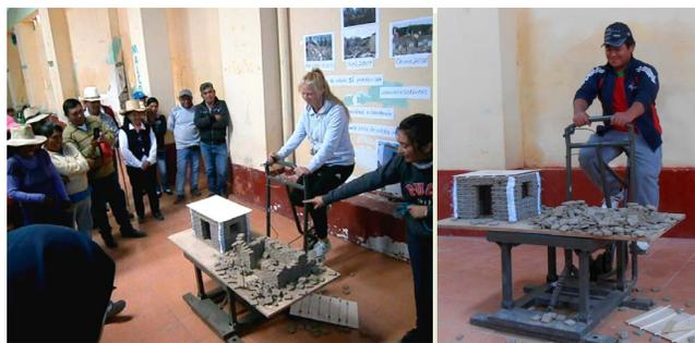
Figura 5 / Demostraciones con la mesa vibratoria portátil PUCP
