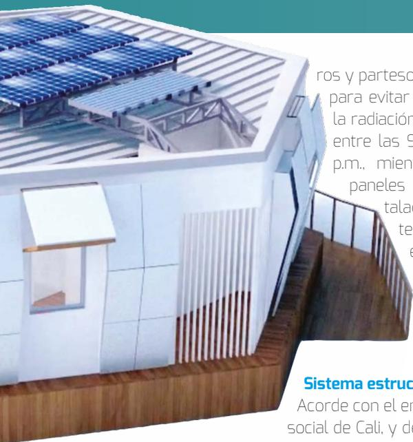
ros y partesoles diseñados para evitar el ingreso de la radiación solar directa entre las 9 a.m. y las 4 p.m., mientras que los paneles solares, instalados sobre el techo, protegen el techo de la incidencia solar directa del sol.
