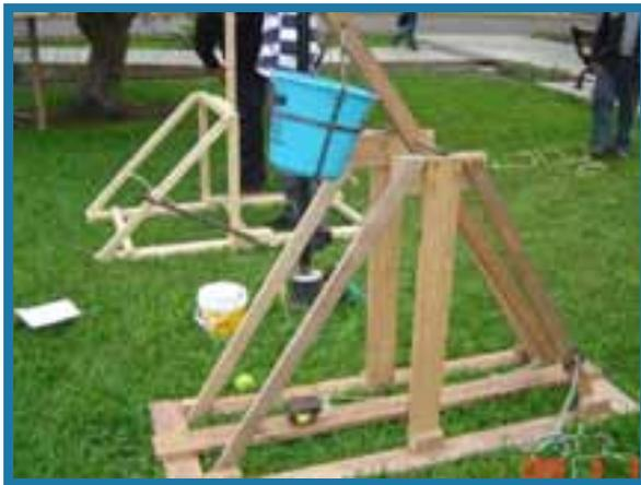
El último diseño de un trabuco exitoso. El alumno lo diseñó de forma que fuera desarmable. En el balde, se colocó arena como contrapeso.
