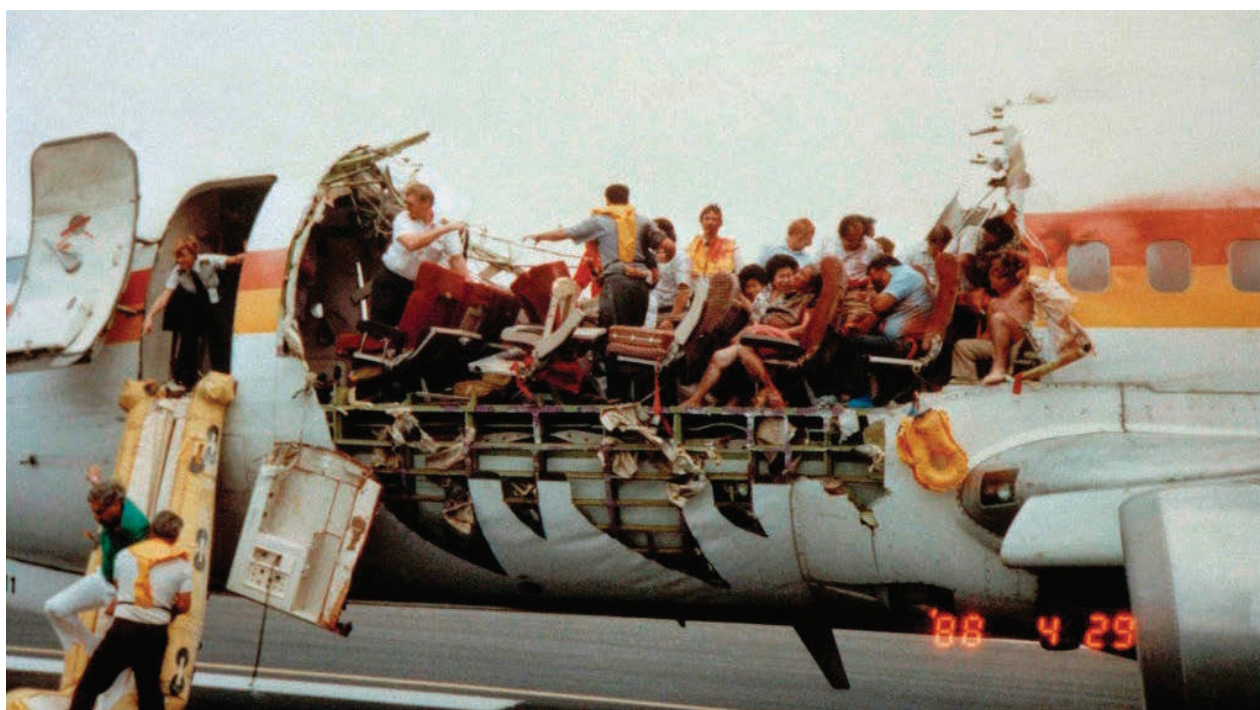
Figura 4. Caso grave de corrosión-fatiga sufrida por los metales del fuselaje del vuelo Aloha Flight 243 en 1988. (Fuente: Blog "Una breve historia"; acceso: mayo 2016 http://www.unabrevehistoria.com/2008_09_01_archive.html (□)).
