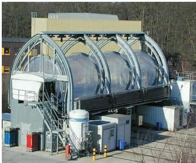
Figura 3. (Derecha) Cámara Atmosférica de Simulación Fotoquímica SA-PHIR de Instituto de Energía e investigación de Clima JÜLICH – Alemania (☒).
