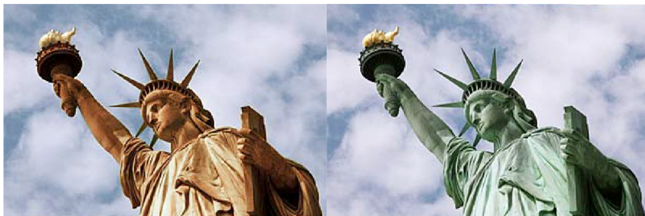
Figura 1. Simulación de cómo debería lucir la Estatua de la Libertad (izquierda) si no se hubiera producido la oxidación del cobre metálico que produjo el color verde (derecha) debido, principalmente, al carbonato de cobre. 3
