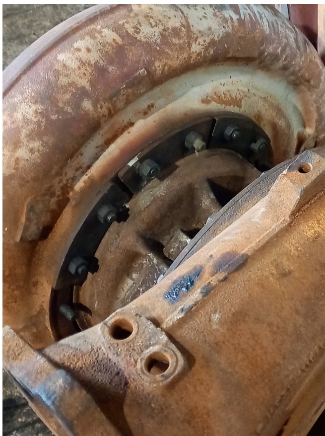
Figura 4. Imagen del caracol del turbo compresor de un motor de combustión interna (Fotografía de las autoras).
