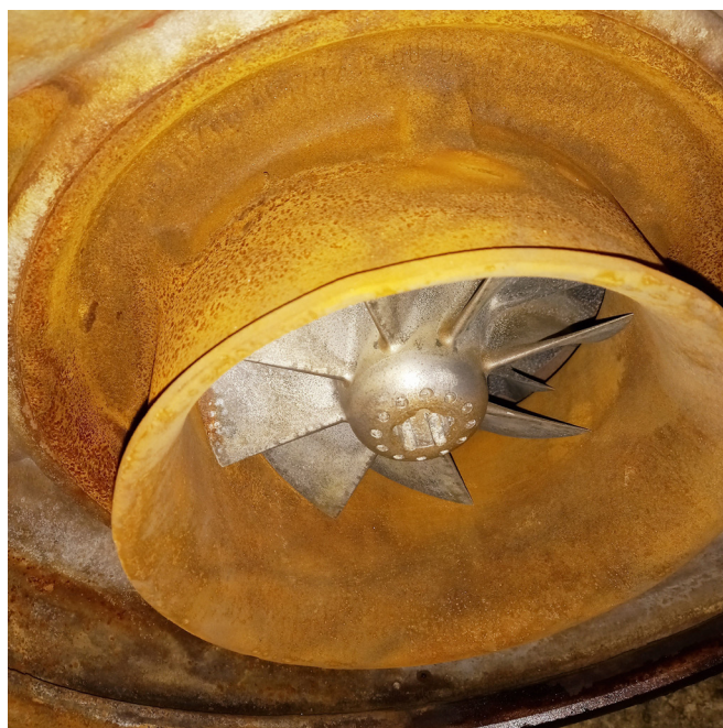
Figura 2. Imagen del caracol del turbo compresor de un motor de combustión interna para la generación de electricidad con oxidación en su superficie. (Fotografía de las autoras)
