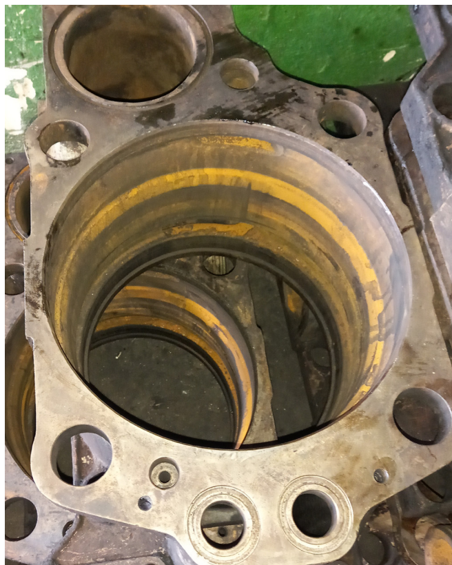
Figura 6. Interior de la culata del motor de combustión interna preservado con inhibidor a base de nitritos (Fotografía de las autoras).
