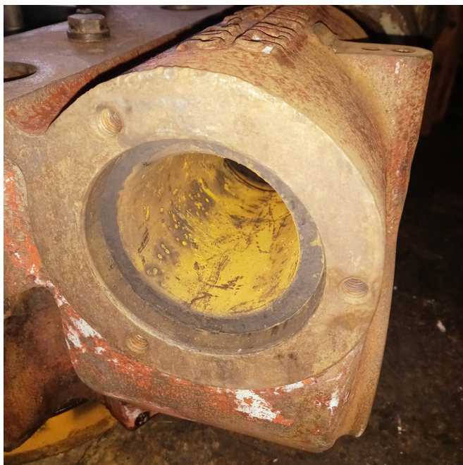
Figura 5. Cámara de agua del sistema de enfriamiento preservado en su interior con inhibidor a base de nitrito. (Fotografía de las autoras)
