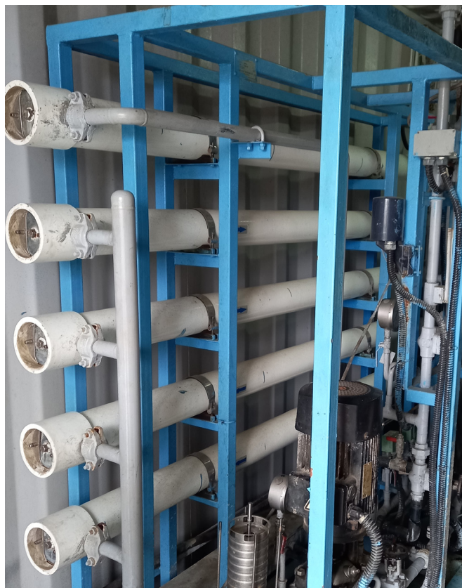
Figura 7. Módulo de membranas de ósmosis inversa (Fotografía de las autoras).
