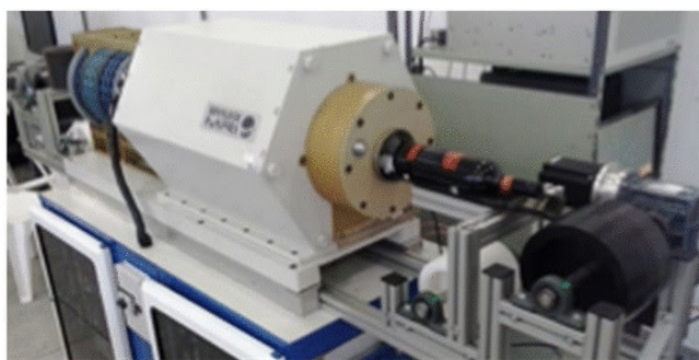
Figura 5. Instrumentos RMN-TD equipados con un conjunto de imanes Halbach se utilizan en Embrapa Instrumentação, São Carlos, Brazil, para analizar productos comerciales envasados. Estos dispositivos cuentan con una estructura magnética cerrada que posiciona las muestras dentro de una región de bobina que mantiene un campo magnético constante y homogéneo. A) Espectrómetro RMN-TD modelo Specfit HR 100 con una frecuencia de resonancia de 4,2 MHz para ^1\text{H} . B) Espectrómetro RMN-TD Halbach Spinlock, modelo SKL-IF-1399, que opera a una frecuencia de resonancia de 9 MHz para ^1\text{H} . Imagen de los autores.
