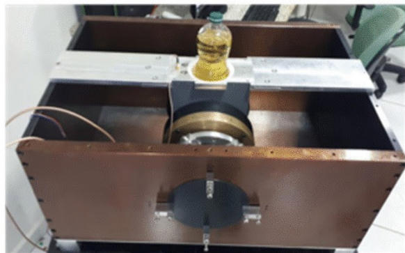
Figura 5. Instrumentos RMN-TD equipados con un conjunto de imanes Halbach se utilizan en Embrapa Instrumentação, São Carlos, Brazil, para analizar productos comerciales envasados. Estos dispositivos cuentan con una estructura magnética cerrada que posiciona las muestras dentro de una región de bobina que mantiene un campo magnético constante y homogéneo. A) Espectrómetro RMN-TD modelo Specfit HR 100 con una frecuencia de resonancia de 4,2 MHz para ^1\text{H} . B) Espectrómetro RMN-TD Halbach Spinlock, modelo SKL-IF-1399, que opera a una frecuencia de resonancia de 9 MHz para ^1\text{H} . Imagen de los autores.
