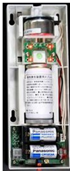
Figura 3. Vista general del interior de la alarma de wasabi y esquema del dispositivo (elaboración propia con imágenes de la compañía pública Air Water Safety Service INC y de la patente PCT/JP2009/051995)
