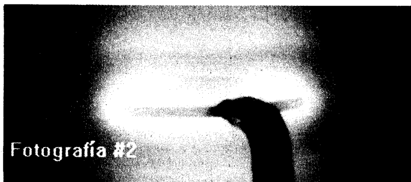
Figura 5. Fotografía del plasma gaseoso, se aprecia la muestra de PTFE sobre el cátodo
