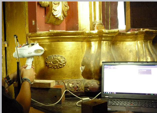
Figura 1: Analizador portátil de fluorescencia de rayos X Tracer III-SD, de Bruker, durante un trabajo de campo en el Retablo de la Virgen de Loreto en la iglesia de San Pedro (Lima, Perú).
