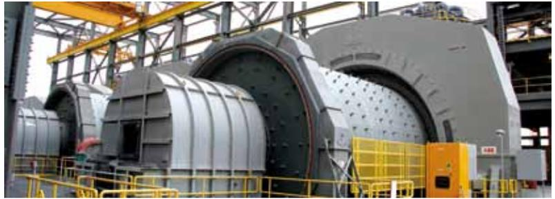
Uno de los sistemas será utilizado para accionar el molino SAG de 42 pies de diámetro y 28 MW de potencia instalada, y los otros dos sistemas serán de 15.6 MW de potencia, los cuales serán empleados en los molinos de bolas de 26 pies de diámetro cada uno.
